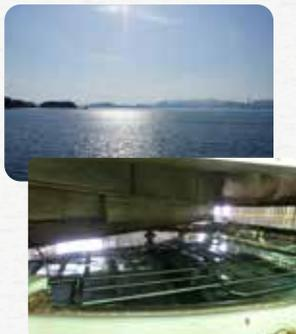
平釜(開放釜)はフライパン状の平鍋を大きくした形の釜。小さな結晶が不揃いに団子状になった凝集晶をつくり、溶けやすく柔らかで食材とのなじみがよく、昔風の塩作りとして利用されている。
